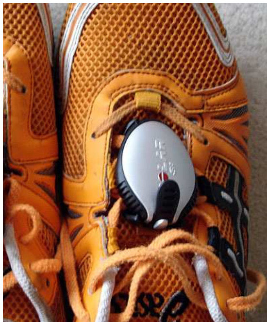
Pilt 2. Polari jooksuandur S3, mis kinnitatakse jooksujalanõu külge. Kaal 21 grammi.
